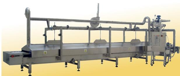
Конструируем конвейерные пастеризаторы непрерывного процесса пастеризации с впрыском пара, реализованные по размерам, согласно требованиям каждого клиента.
