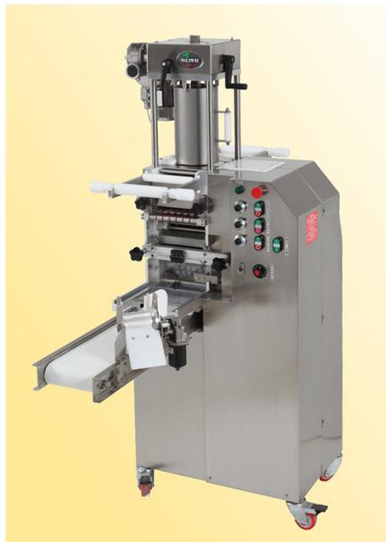
Машины для производства ravioli из двойного слоя теста с поршневым насосом для наполнителя; вместимость ёмкости для наполнителя больших размеров.
